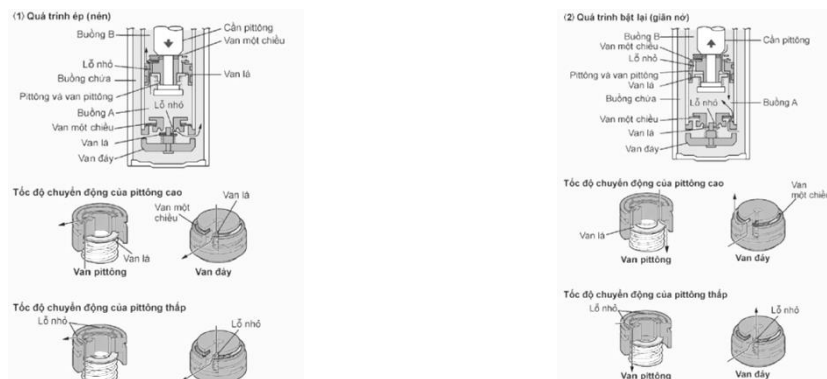
Hình 2.15: Hoạt động của giảm tốc kiểu ống kép
